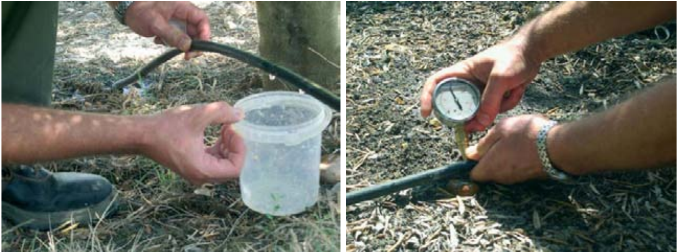
Foto 2. Determinación del caudal suministrado por un emisor y medida de la presión en una evaluación de riego localizado realizada por el SAR.
