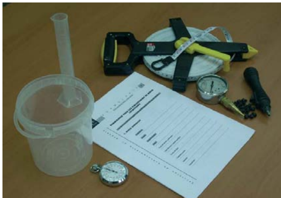
Foto 1. Material utilizado para el trabajo de campo en las evaluaciones de riego localizado realizadas por el SAR.
