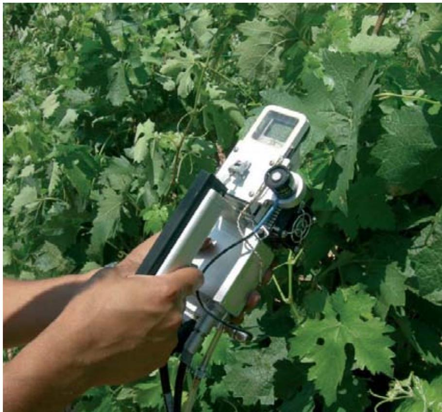
Pinza de medidor de intercambio de gases IRGA.
