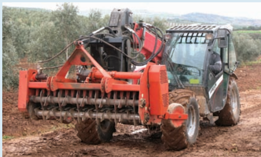
Faresin 7-30 Compact Olitract llevando una trituradora de restos de poda camino del tajo. Como el picado se produce por delante del vehículo, las ruedas nunca pisan las ramas antes de picarlas.
