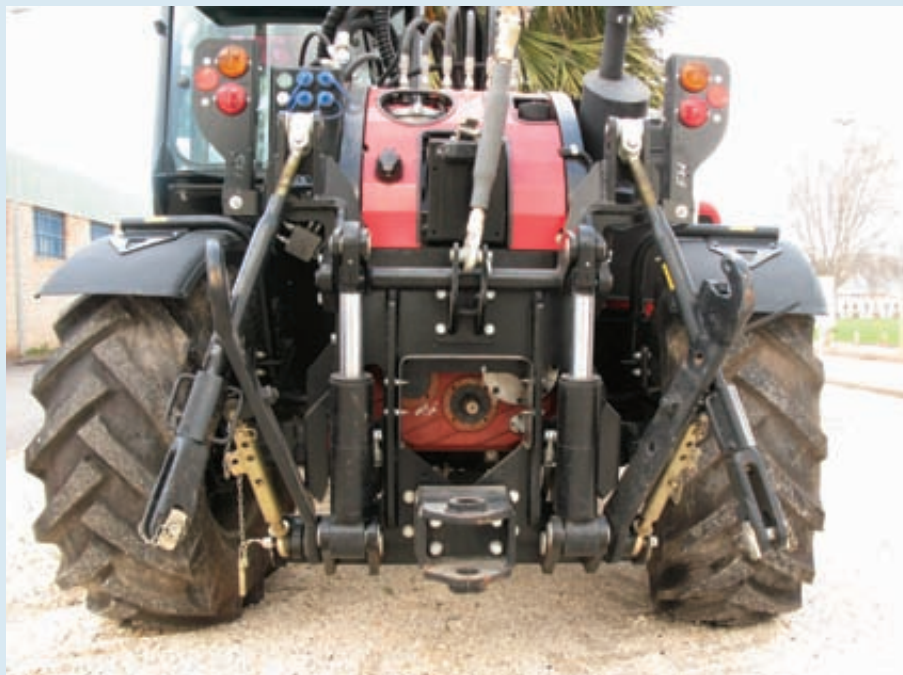
Vista trasera del vehículo Faresin 7-30 Compact Olitract con todos los elementos de acoplamiento de un tractor estándar. Obsérvense los dos fuertes cilindros para tener una gran capacidad de elevación de aperos suspendidos. Los brazos elevadores están plegados para transporte.
