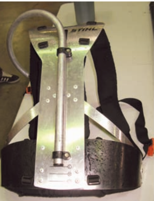
Foto 2. Arnés para sujetar la podadora en altura HT 131. Obsérvese que el brazo del cual cuelga la podadora se puede regular en tres posiciones en la trasera del arnés en función de la envergadura del operario. El trabajo resulta poco cansado y el operario se limita a alejarse del árbol con la barra poco inclinada si corta una rama a poca altura, o acercarse dando más inclinación a la barra para alcanzar más altura.
