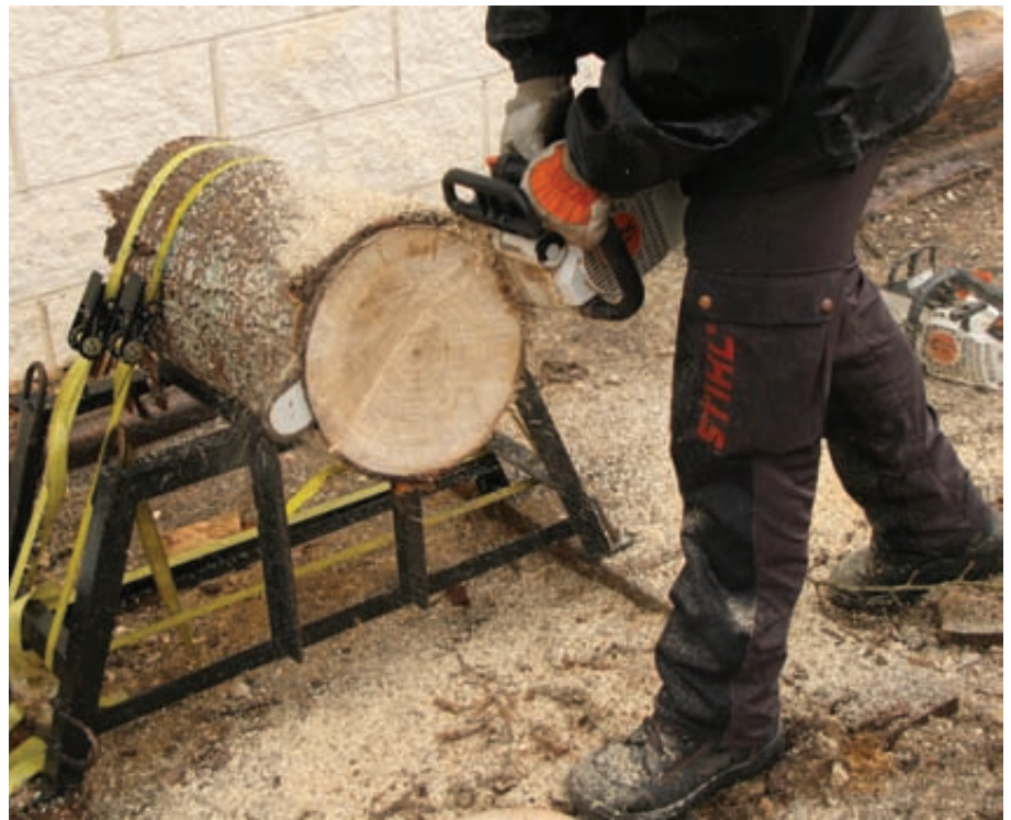
Foto 6. En caso necesario, con las motosierras MS 192 T y MS 200 T también se pueden cortar troncos de unos 30 cm de diámetro.
