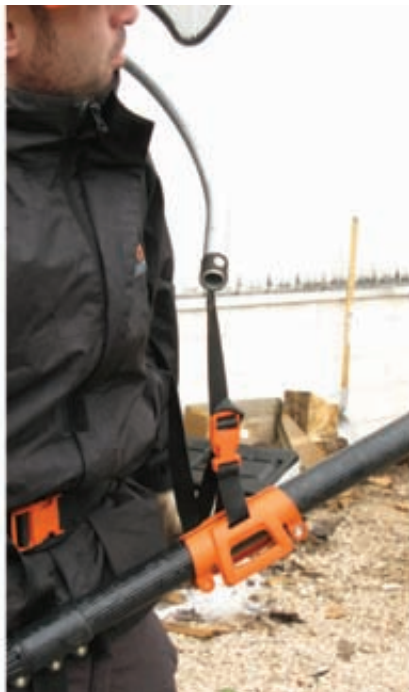
Foto 2. Arnés para sujetar la podadora en altura HT 131. Obsérvese que el brazo del cual cuelga la podadora se puede regular en tres posiciones en la trasera del arnés en función de la envergadura del operario. El trabajo resulta poco cansado y el operario se limita a alejarse del árbol con la barra poco inclinada si corta una rama a poca altura, o acercarse dando más inclinación a la barra para alcanzar más altura.
