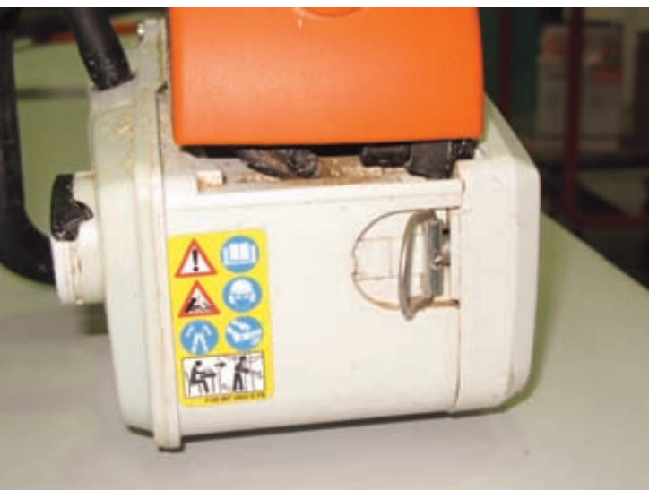
Foto 5. Anilla situada en el extremo trasero de las motosierras MS 192 T y MS 200 T para colgarlas de alguna correa que se lleve en la cintura mientras el operario se agarra a las ramas de los árboles en busca de la mejor posición para cortar.
