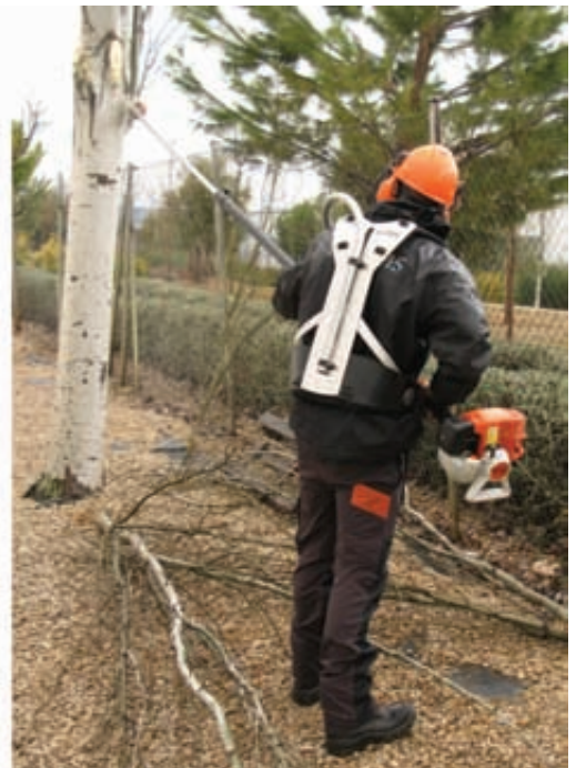
Foto 2. Arnés para sujetar la podadora en altura HT 131. Obsérvese que el brazo del cual cuelga la podadora se puede regular en tres posiciones en la trasera del arnés en función de la envergadura del operario. El trabajo resulta poco cansado y el operario se limita a alejarse del árbol con la barra poco inclinada si corta una rama a poca altura, o acercarse dando más inclinación a la barra para alcanzar más altura.
