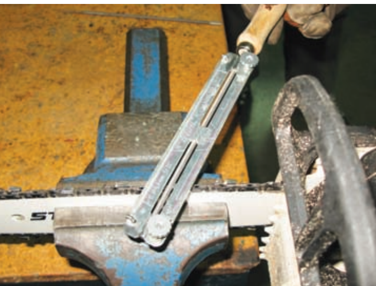
Foto 7. Afilado de la cadena. A la izda: afilado de los dientes con lima delgada cilíndrica y plantilla para mantener la oblicuidad adecuada. Drcha: rebaje de los limitadores de profundidad con una lima plana.
