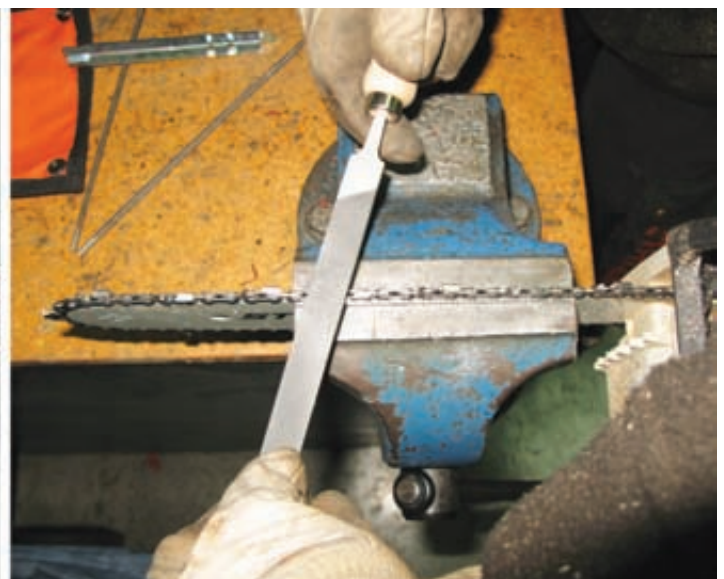
Foto 7. Afilado de la cadena. A la izda: afilado de los dientes con lima delgada cilíndrica y plantilla para mantener la oblicuidad adecuada. Drcha: rebaje de los limitadores de profundidad con una lima plana.
