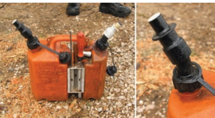
Foto 4. Bidón con dos compartimentos para gasolina y aceite, y detalle de la boquilla que impide que se derrame alguna gota al llenar los pequeños depósitos de las motosierras. Como se consume más volumen de gasolina que de aceite de lubricación, el compartimento para gasolina es mayor que el de aceite.
