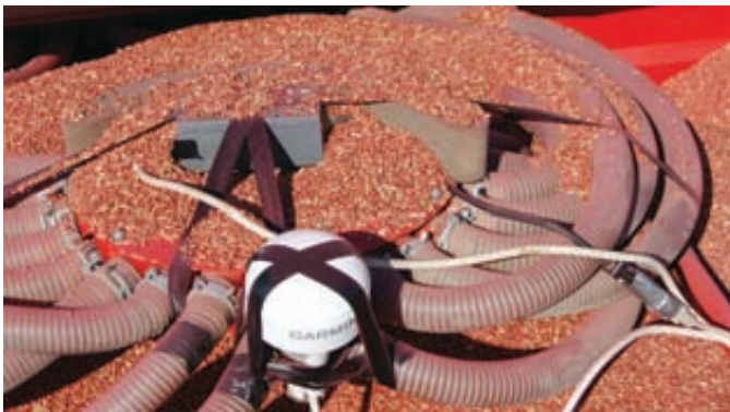
Foto 3. Detalle del GPS situado en el centro del distribuidor de la sembradora.
