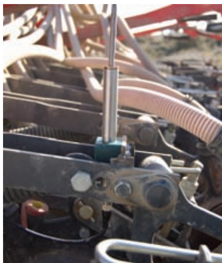
Foto 4. Detalle del LVDT colocado en el segundo brazo de siembra.
