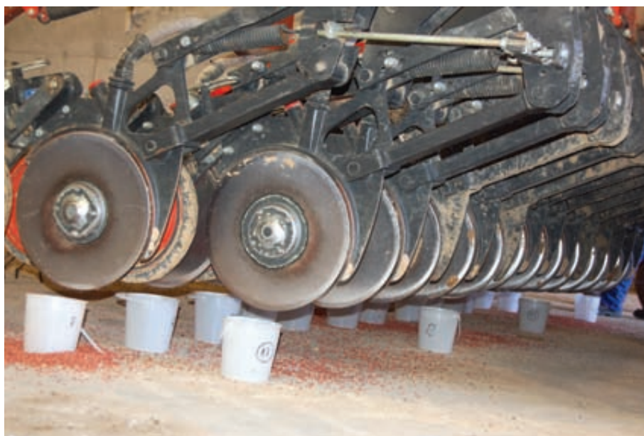
Foto 9. Ensayo estático para la evaluación de la homogeneidad de la distribución de las semillas en las líneas de siembra. Las semillas que se ven en el suelo corresponden a restos de pruebas previas de este ensayo en las que no se recogía el material en recipientes.
