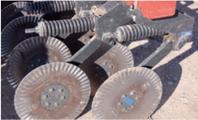
Foto 2. Detalle de los discos abridores del surco.
