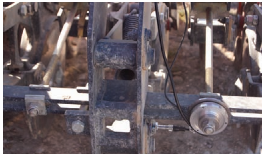
Foto 5. Detalle de la célula de carga instalada en el segundo brazo de siembra.
