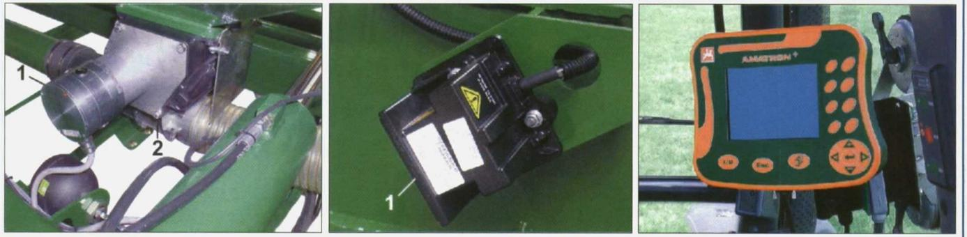
vertible, el ajuste de cada una de las rastras de precisión se realiza mediante una llave de carraca guardada en los cartuchos de almacenamiento (figura 1), mientras que la presión se ajusta por segmentos tensando un
