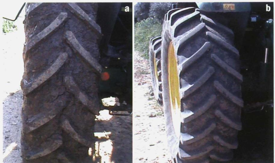
Foto 5. Neumáticos ensayados: (a) convencionales; (b) baja presión.
