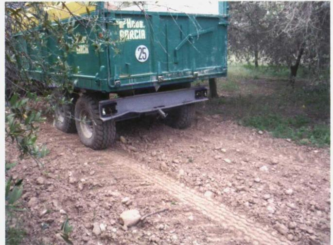
Fotos 1 y 2 (arriba). Efectos sobre el suelo del tránsito de maquinaria. Foto 3 (abajo, izda.). Parcela de realización de los ensayos. Foto 4 (derecha). Pase de ensayo con una máquina.
