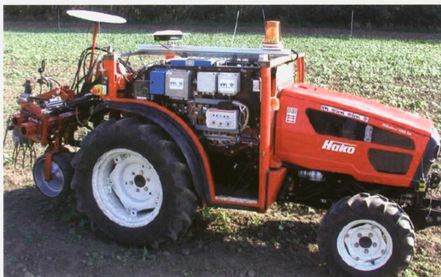
Tractor automático Hakotrac 3000 con sistemas RTK-GPS (escarda mecánica dentro de la hilera) (KVL Denmark).
