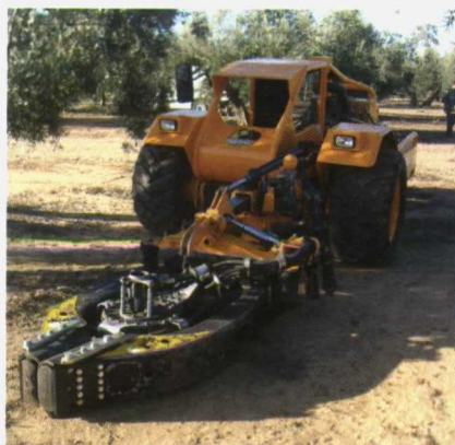
Foto 17. Sacudidor de copa adaptado a trabajar en olivar intensivo. Foto 18 (centro). Vibrador autopropulsado de tipo triciclo. Foto 19 (derecha). Sacudidor de copa trabajando en círculo sobre un olivar tradicional.
