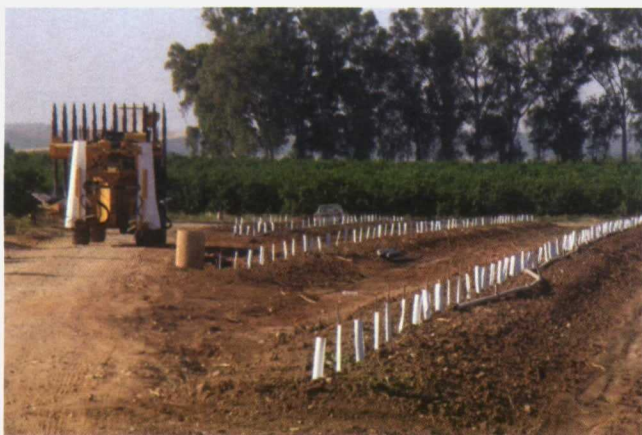
Foto 7. Cosechadora integral de cítricos desplazándose junto a plantaciones reestructuradas (al fondo y a su izquierda) para poder usarla.
