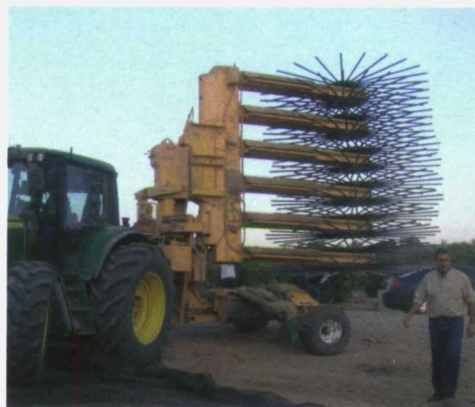
Foto 17. Sacudidor de copa adaptado a trabajar en olivar intensivo. Foto 18 (centro). Vibrador autopropulsado de tipo triciclo. Foto 19 (derecha). Sacudidor de copa trabajando en círculo sobre un olivar tradicional.
