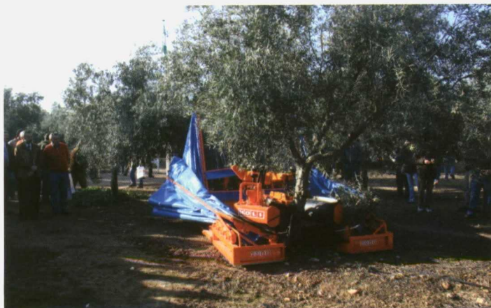
Fotos 10 y 11. Vibradores con paraguas para la recolección integral de un olivar intensivo.
