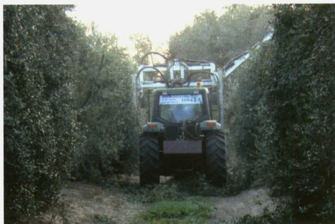
Foto 8. Vibrador de troncos orbital. Foto 9. Podadora mecánica en un olivar intensivo para adaptarlo a la recolección con sacudidores de follaje.
