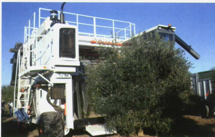
Foto 15. Cosechadora cabalgante para olivar intensivo. Foto 16 (derecha). Sacudidor de copa con plataforma de recogida y sistema de descarga continuo a remolque.
