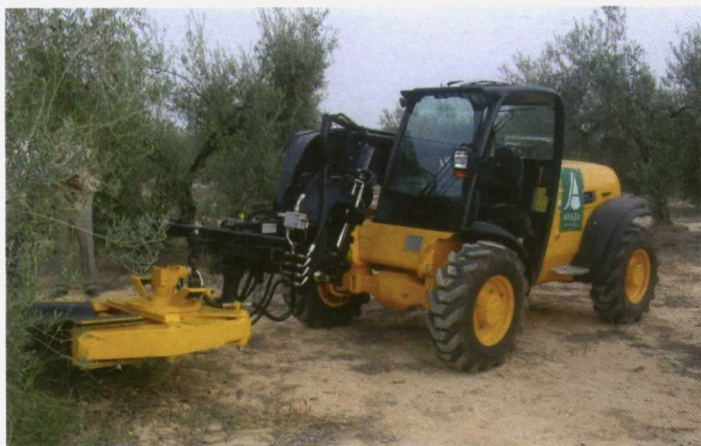
Foto 8. Vibrador de troncos orbital. Foto 9. Podadora mecánica en un olivar intensivo para adaptarlo a la recolección con sacudidores de follaje.
