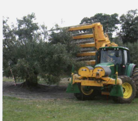
Foto 17. Sacudidor de copa adaptado a trabajar en olivar intensivo. Foto 18 (centro). Vibrador autopropulsado de tipo triciclo. Foto 19 (derecha). Sacudidor de copa trabajando en círculo sobre un olivar tradicional.
