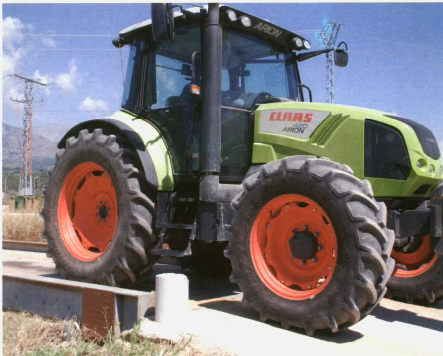
El tractor tiene un peso total ajustado (ligeramente inferior a 5.000 kg) que se distribuye al 50% entre el eje trasero y el delantero, admitiendo un contrapeso frontal máximo de 720 kg.
