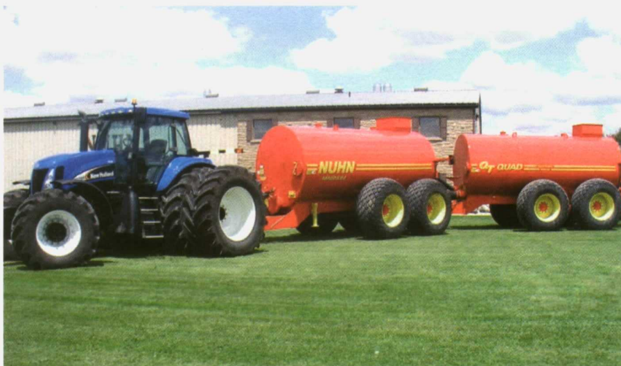
Foto 4. Las grandes explotaciones tienden a adquirir sistemas de hasta cuatro ejes con chasis articulado.
