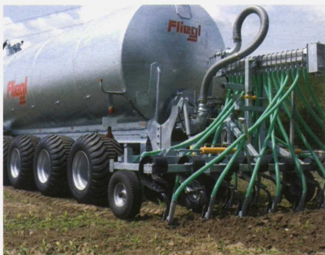
Foto 6. Cisterna distribuidora de cuatro ejes, con inyección localizada mediante rejillas abresurco.
