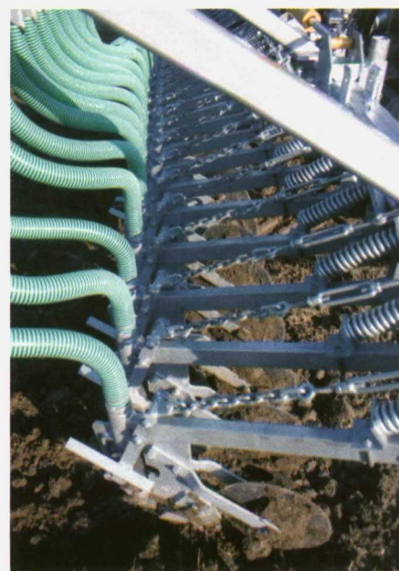
Foto 5. Los sistemas de inyección o enterrado del fertilizante mediante discos o rejas son los menos perjudiciales medioambientalmente.
