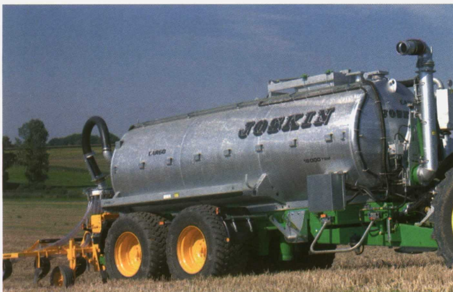
Foto 5. Los sistemas de inyección o enterrado del fertilizante mediante discos o rejas son los menos perjudiciales medioambientalmente.
