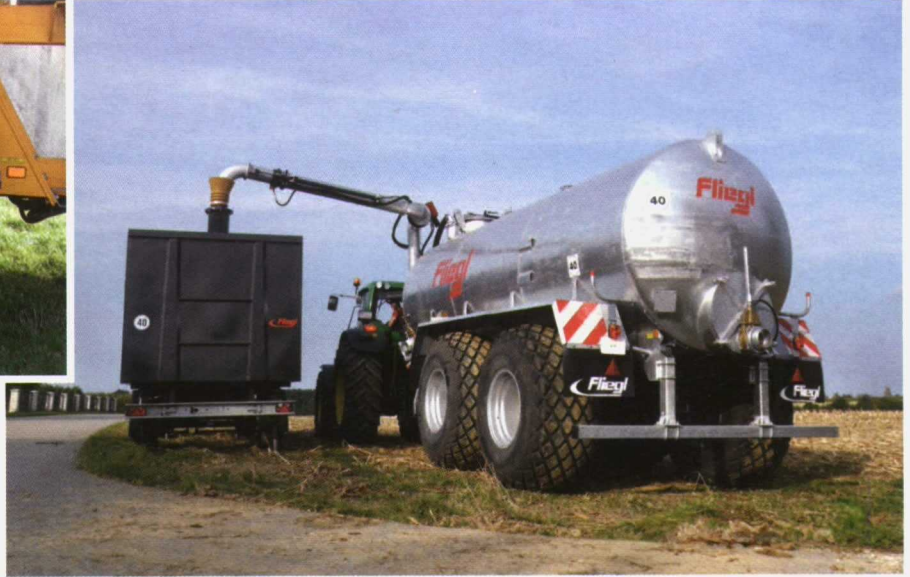
Foto 2 (arriba izda.). Los sistemas de inflado automático de las ruedas de los grandes remolques distribuidores son imprescindibles para disminuir automáticamente la presión y reducir la compactación en parcela. Foto 3 (derecha). Las nuevas tendencias apuntan a la separación entre transporte y distribución, empleando camiones o depósitos en el lateral de la parcela.
