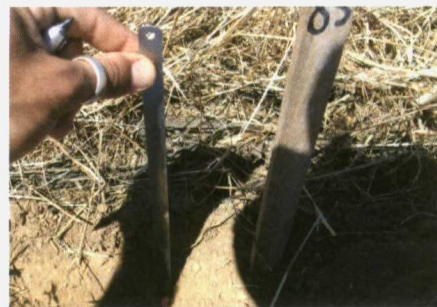
Foto 4. Comprobación de la profundidad de siembra real establecida por la sembradora (UPM-ESAEIvas).
