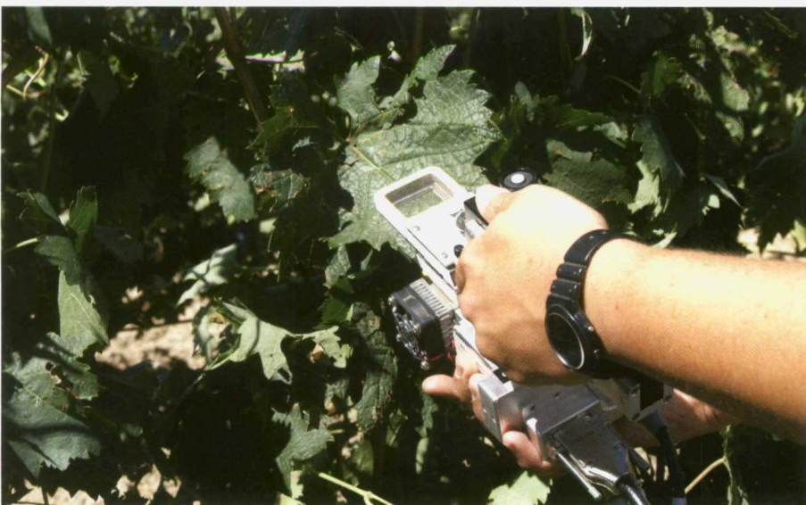
Medida de fotosíntesis mediante IRGA.
