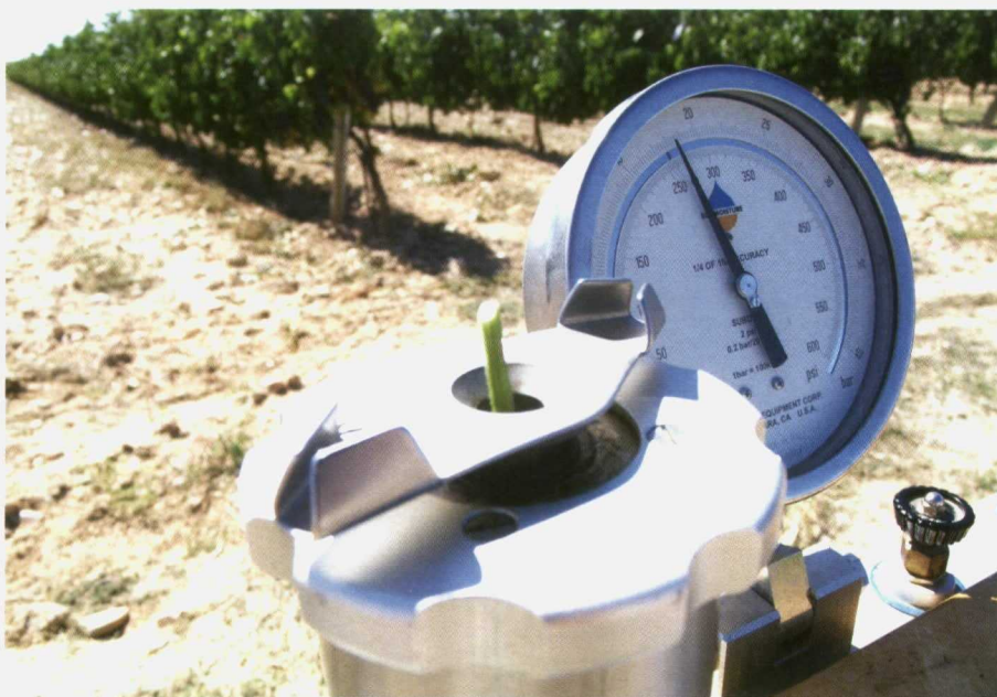
Potencial hídrico medido en el peciolo de la hoja en una cámara de presión.
