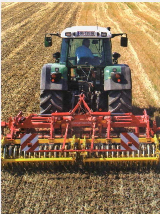
Foto 3 (izda.). Apero combinado formado por grada y rodillo haciendo una labor superficial propia de mínimo laboreo.
