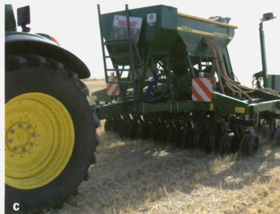
Foto 6 (a, b y c). Sembradoras de siembra directa capaces de sembrar sobre un terreno no labrado. Detalle de los discos y rejas abresurcos.
