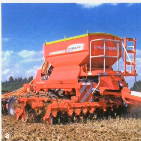
Foto 5 (a y b). Sembradoras que llevan instalado en la parte delantera un apero para labrar y sembrar simultáneamente.
