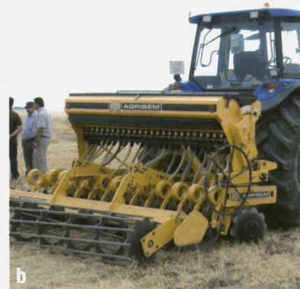
Foto 5 (a y b). Sembradoras que llevan instalado en la parte delantera un apero para labrar y sembrar simultáneamente.
