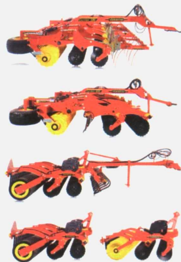
Foto 3 (izda.). Apero combinado formado por grada y rodillo haciendo una labor superficial propia de mínimo laboreo.
