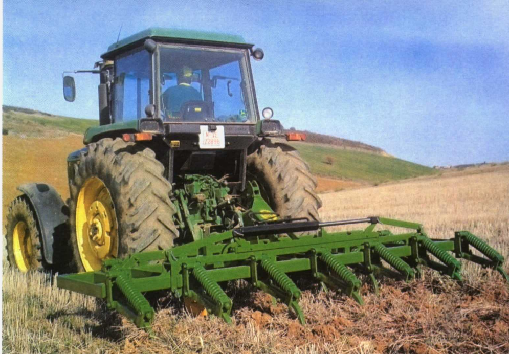
Foto 2. Arado cincel agrietando el terreno sin voltearlo.
