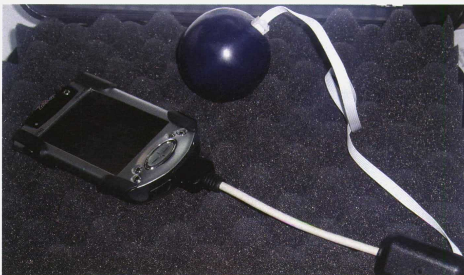
El fruto electrónico, una vez programado, se introduce en la maquinaria agrícola y va registrando en tiempo real los impactos que sufre, el momento del impacto y su magnitud (imagen EPSH-UZA).
