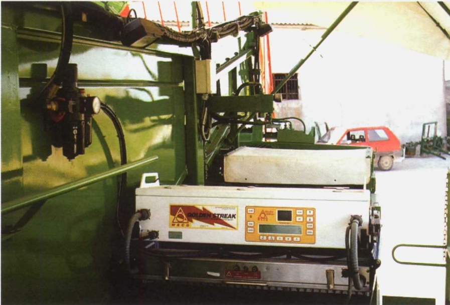
Detalle de la zona de clasificación del producto a bordo de la cosechadora, y el selector óptico existente.
