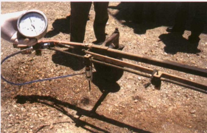
Foto 10. Presión en el extremo de una barra: no debe variar más del 10% de la que marca el manómetro del equipo.
