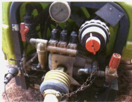
Foto 8. Equipo con elemento de medida en mal estado: manómetro ilegible.
