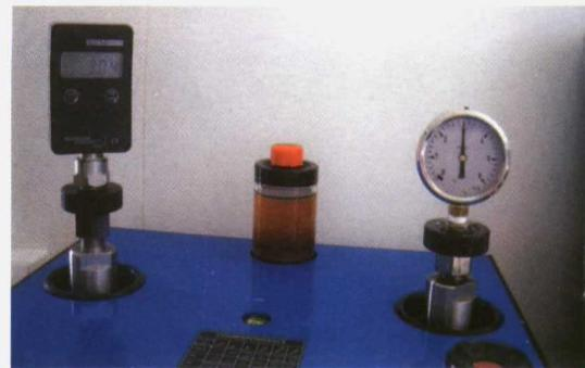
Foto 9. Contrastador de manómetros donde se observa que el manómetro patrón señala una presión casi exacta a la del manómetro de prueba en el banco de medidas.
