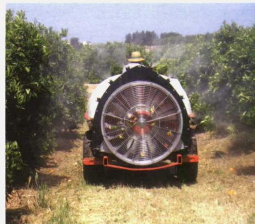
Foto 2. Pulverizadores hidroneumáticos (atomizadores).
