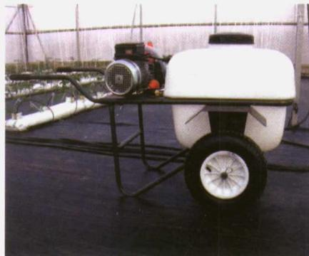
Foto 7. Pulverizador hidráulico de chorro proyectado con pistola de aplicación.
