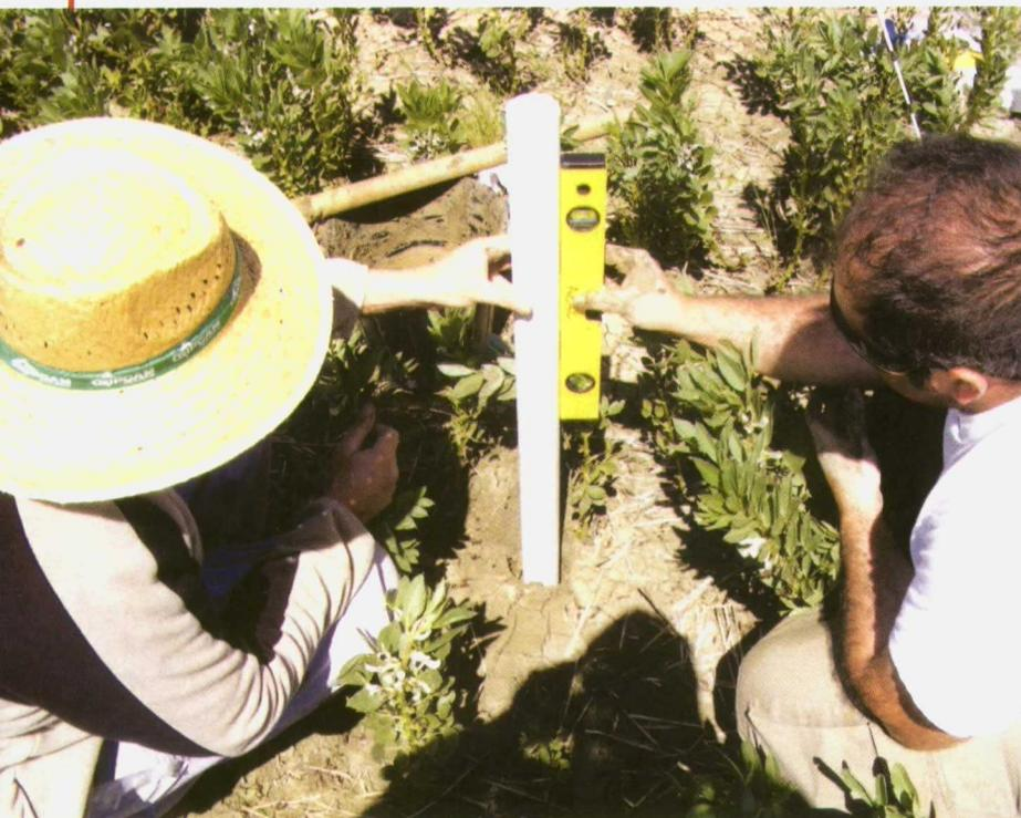
Colocación de tubos para la medición de humedad en el suelo en las fincas piloto.
