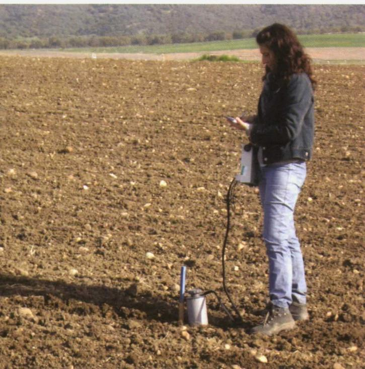
Medición de emisiones de CO<sub>2</sub> procedentes del suelo tras la realización de una labor.
