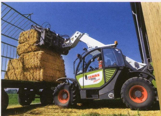
En el extremo de la pluma el operador puede acoplar distintos accesorios como horquillas carga pacas.
