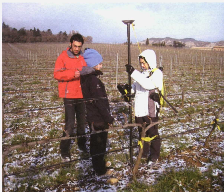
Foto 1. Levantamiento de los puntos de muestreo en el viñedo mediante un receptor Trimble 5700 (Trimble, California), y corregidos en tiempo real con la red GNSS de La Rioja.
