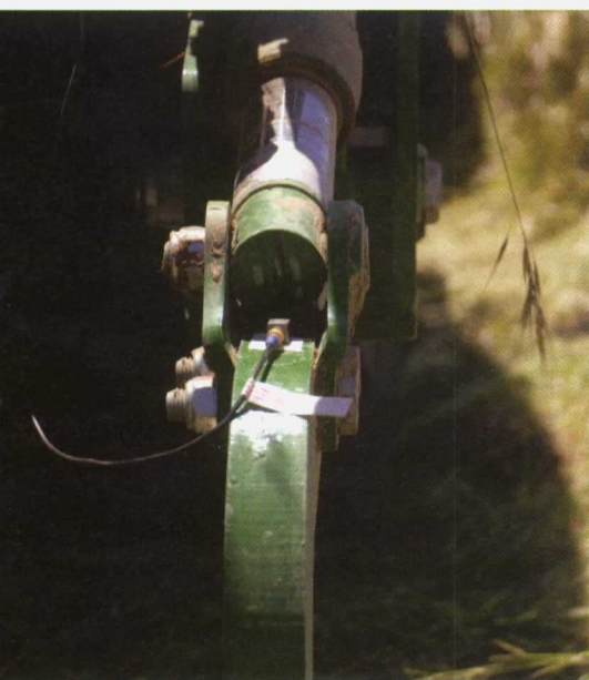
Foto 5. Detalle de un acelerómetro triaxial colocado en el primer brazo del arado.
