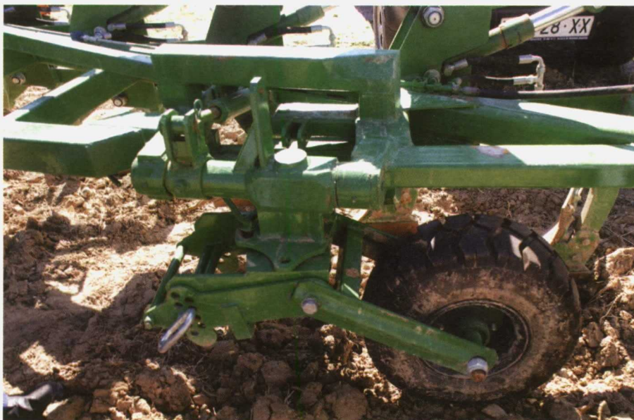
Foto 2. Rueda de apoyo para el control de profundidad y el transporte.
