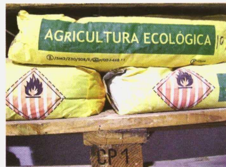
Dos palets de dicloropropeno (producto inflamable y tóxico) en el sector de almacenamiento de productos tóxicos e inflamables y azufre (sólido inflamable) para agricultura ecológica.
