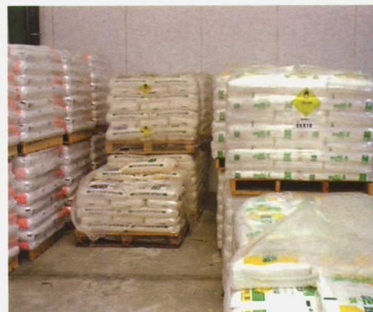
Palets de nitrato potásico (comburente) en su sector de almacenamiento.
