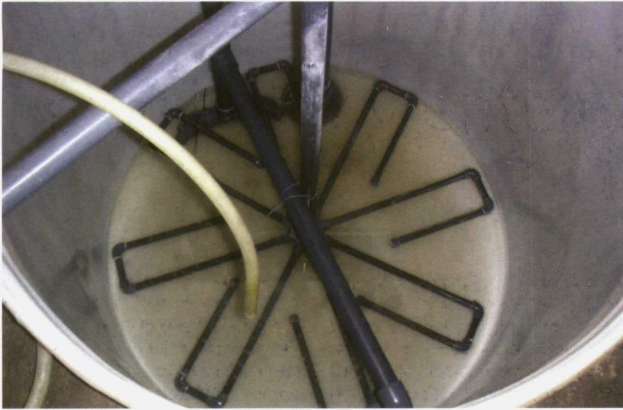
Foto 5. Sistema frecuentemente utilizado para facilitar la labor disolución de los fertilizantes sólidos (burbujeo de aire a presión).
