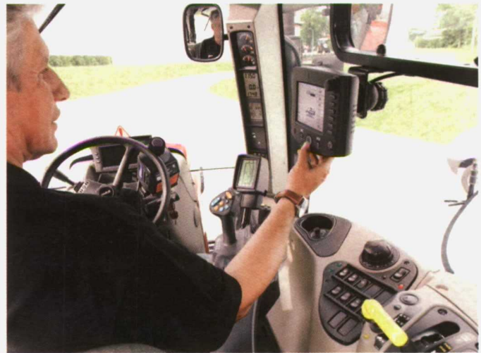
Uno de los elementos clave en la agricultura de precisión es el monitor de control y grabación de datos, bien sea con un sistema o estándar o bien con un terminal virtual, que integre la señal de todos los sensores y la almacene para poder representarla y estudiarla posteriormente.
