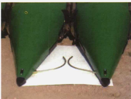
Con el AutoTrac RowSense de John Deere, los sensores localizados en el cabezal de maíz proporcionan un perfecto seguimiento de la hilera.
