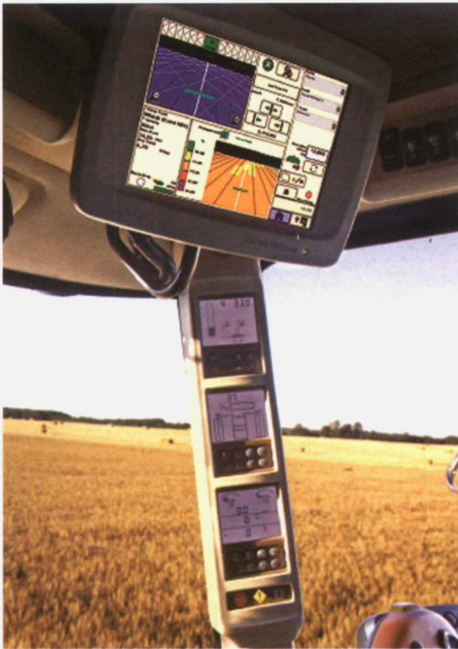
Uno de los elementos clave en la agricultura de precisión es el monitor de control y grabación de datos, bien sea con un sistema o estándar o bien con un terminal virtual, que integre la señal de todos los sensores y la almacene para poder representarla y estudiarla posteriormente.
