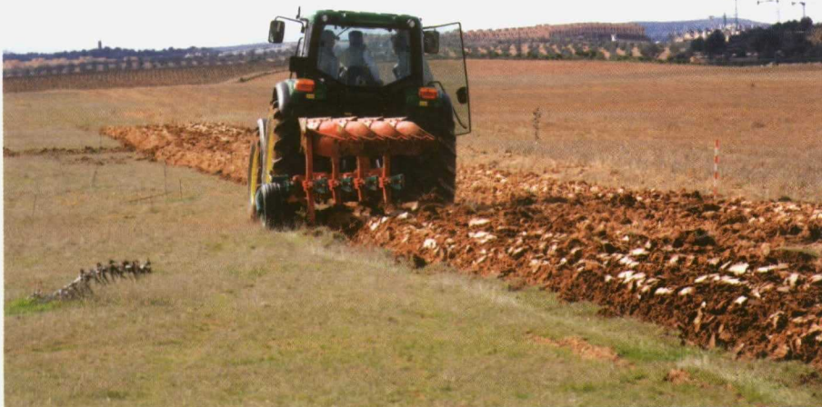
Trabajo realizado por el JD 6534 con la vertedera Kverneland ES 85 de cuatro cuerpos.
