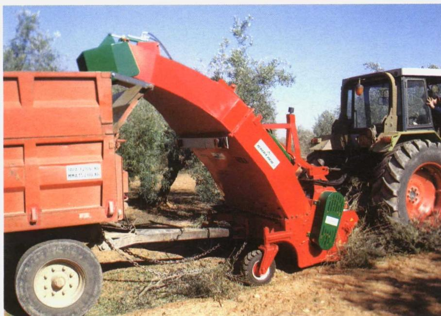
**Foto 9. Picadora autoalimentada con descarga a remolque.**
