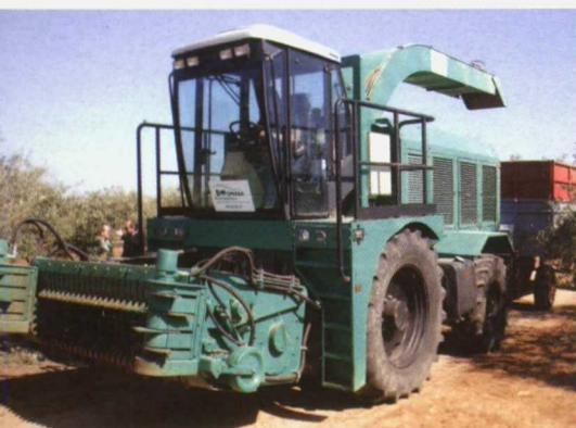
**Foto 13.** Picadora autoalimentada autopropulsada.
