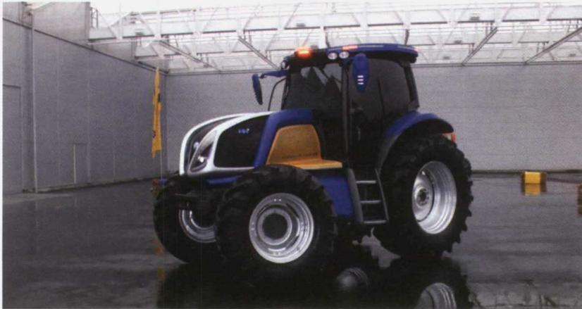
El tractor NH² de New Holland funciona con hidrógeno y expulsa al exterior vapor de agua, por lo que es actualmente la tecnología más limpia que existe.
