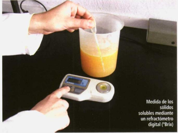
Medida de los sólidos solubles mediante un refractómetro digital (°Brix)
