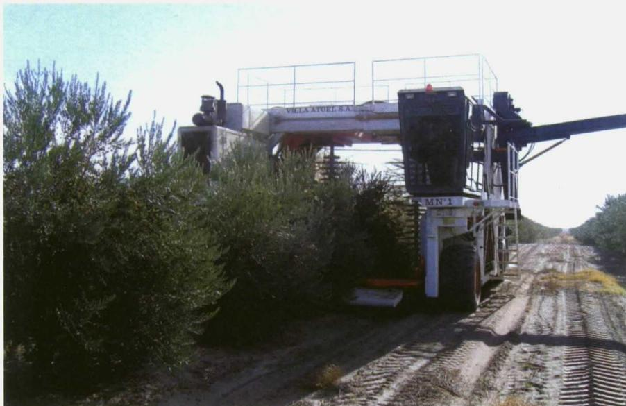
Foto 4. Cosechadora integral de aceitunas (Colossus) que puede recolectar plantaciones intensivas formadas en vaso o en eje central. Esta máquina de grandes dimensiones (5-4 m de alto x 4 m de ancho) se ha introducido recientemente en grandes explotaciones de Andalucía y Portugal.
