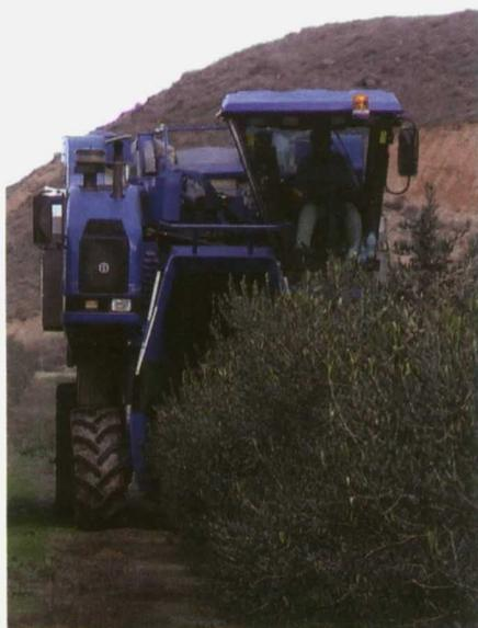
Foto 5. Máquina cabalgante utilizada para la recogida de aceitunas en plantaciones en seto.
