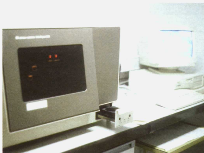
Foto 2. NIRS para la determinación del contenido de proteína y fibra bruta.
