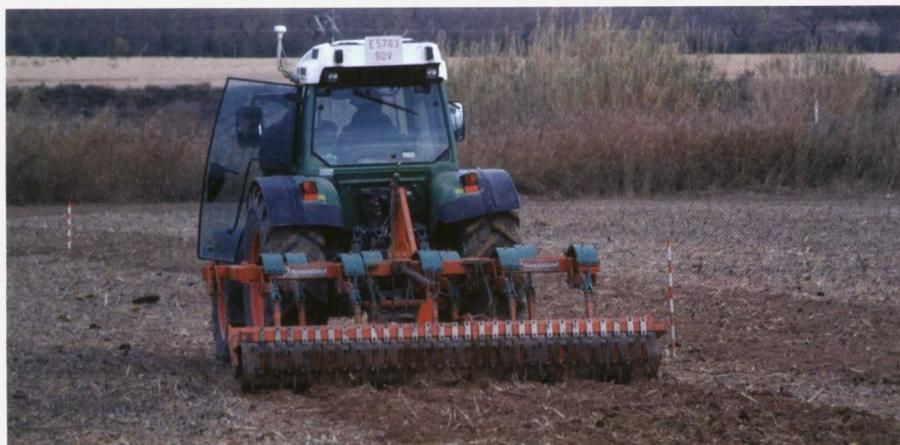
Labor con chisel Kverneland CLM de 9 brazos montado sobre el Fendt 209.
