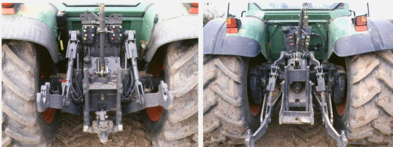
Vista posterior. El tractor 209 (derecha) muestra reducciones finales en tandem mientras que en el 211 Vario (izquierda) son de tipo planetario.
