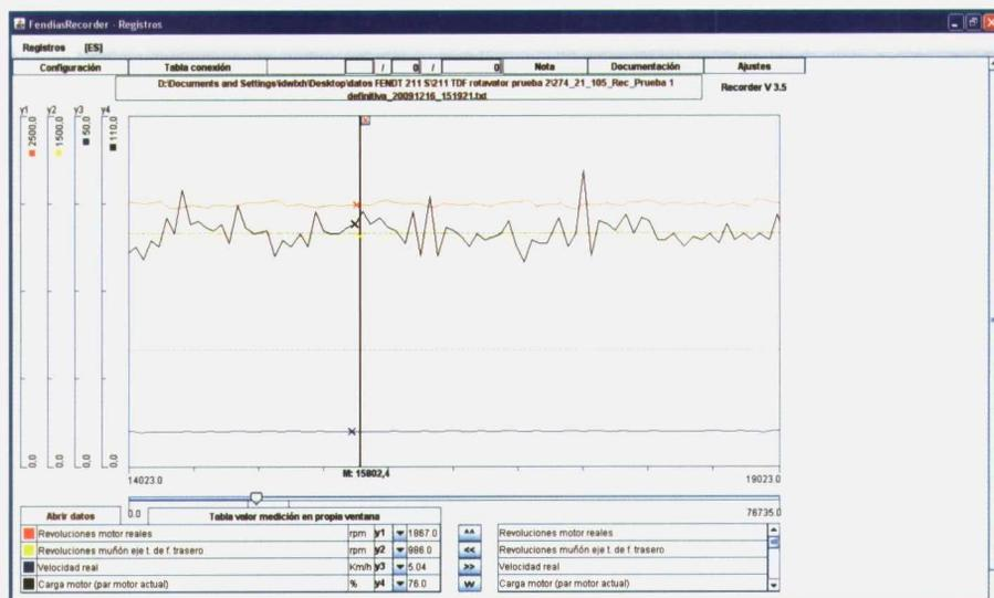
el modelo 209 (0,30 y 0,42 km/h, respectivamente). La mayor variabilidad en la velocidad real de avance se produjo en ambos tractores en las condiciones de trabajo del chisel a 22 cm de profundidad (0,52 y 0,59 km/h para el 211 Vario y 209, respectivamente).
