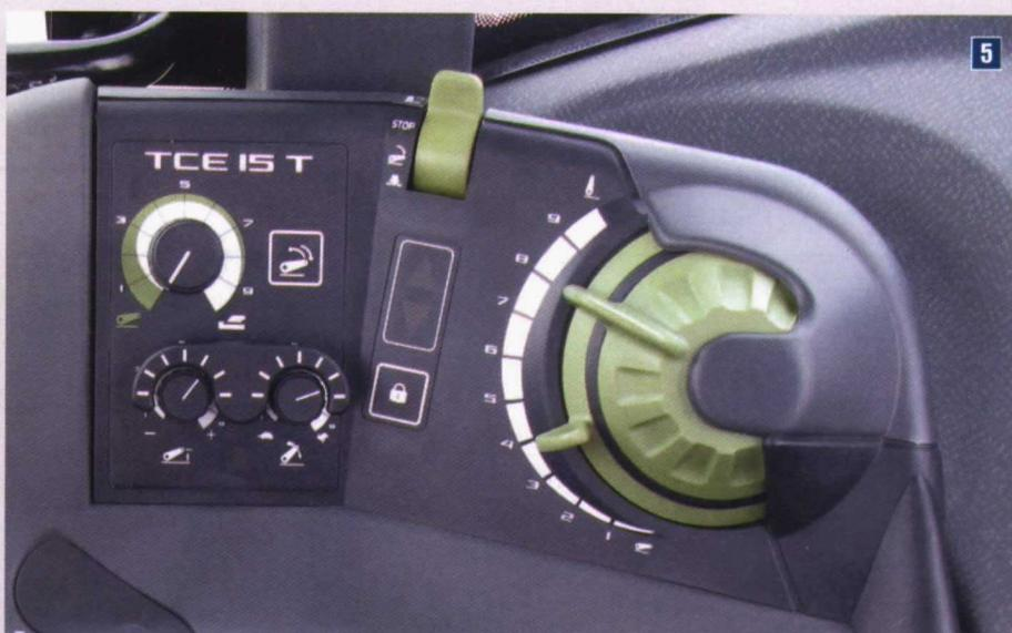
Foto 5. Mandos para comandar la altura de los brazos elevadores. A la derecha, rueda para fijar el control de altura. A la izquierda, debajo de las letras TCE, rueda para fijar el control de esfuerzo en mayor o menor proporción.
