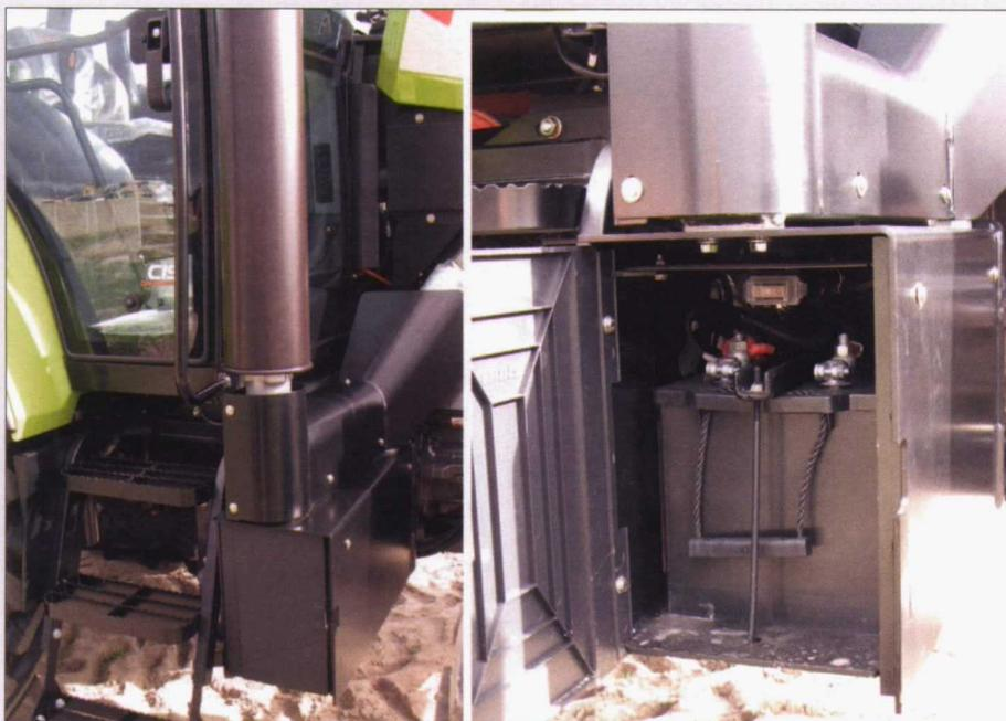
Foto 10. Tramo vertical del tubo de escape y detalle de la batería situada debajo de su inicio.
