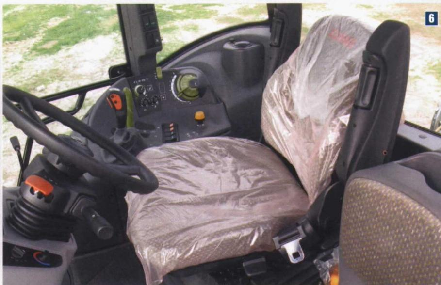
Foto 6. Asiento ligeramente girado hacia la derecha para que el conductor encare mejor los mandos situados en ese lado.
