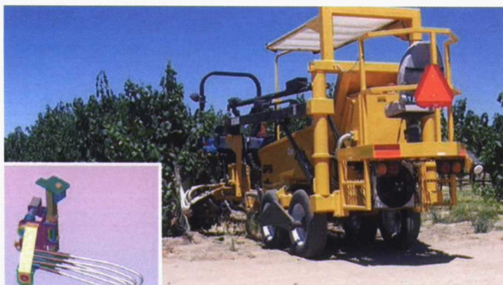
Izquierda: Maquinaria empleada en el sistema vMECH para reducir la carga de frutos y ajustar la productividad superficial deseada (fruit thinning).
