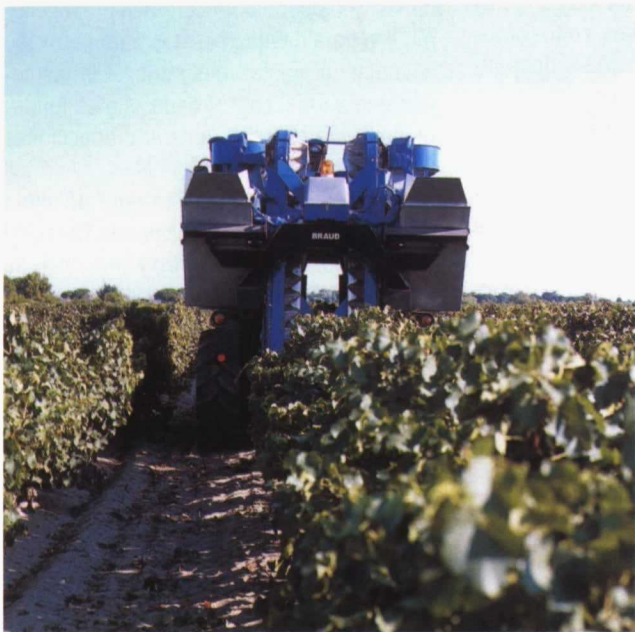
Vendimiadora New Holland para distancias inter-cepa estrechas.
