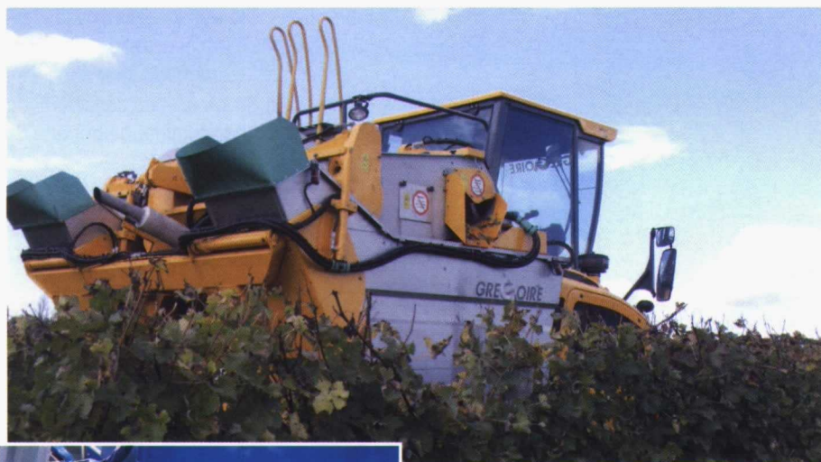
Sistemas de despaillado: lineal (izda.) y rotativo (arriba).
