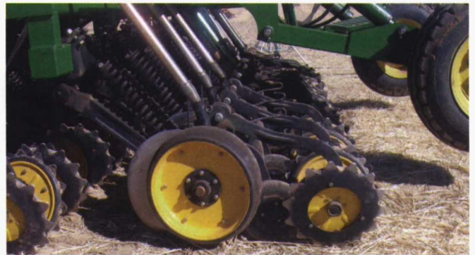
En el caso de que la sembradora solo tenga un disco para la apertura del surco, normal en las sembradoras a chorrillo, la semilla se deposita en el lateral del mismo.
