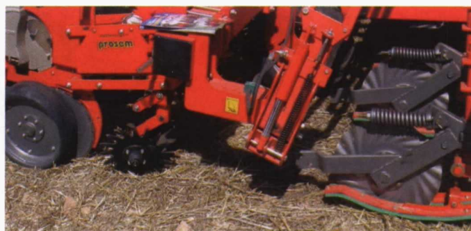
Foto izquierda. Elementos del tren de siembra con discos, de derecha a izquierda: disco turbo, disco abridor de surco, doble disco sembrador, rueda de control de profundidad, ruedas tapadoras compactadoras.
