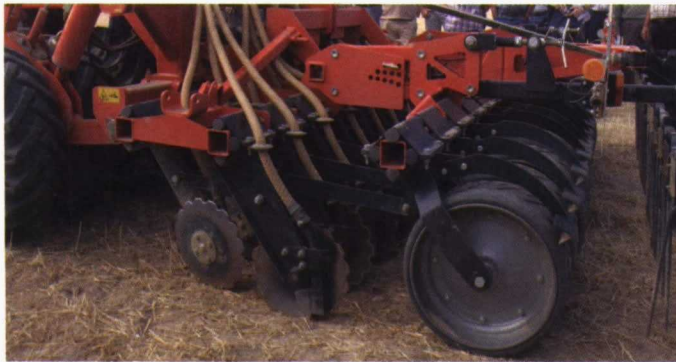
En el caso de que la sembradora solo tenga un disco para la apertura del surco, normal en las sembradoras a chorrillo, la semilla se deposita en el lateral del mismo.
