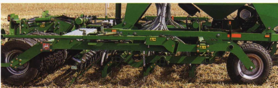
Elementos de tren de siembra con rejas, de derecha a izquierda: reja con dispositivo de siembra, rastra flexible tapadora de surco.
