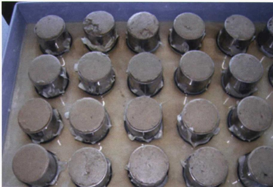
Foto 2. Cilindros de muestras inalteradas equilibrándose en el lecho arenoso.
