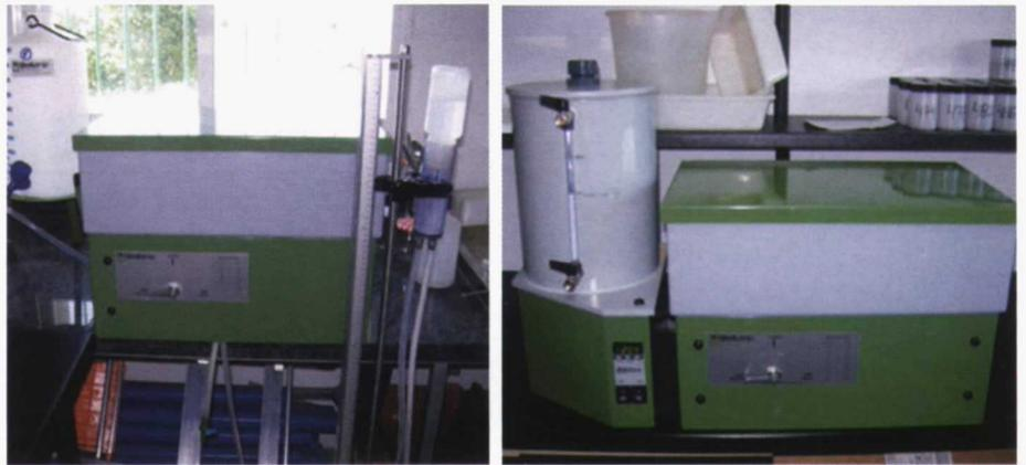
Foto 3. Caja de arena (izq.) y arena-kaolín (dcha.) para la obtención de las curvas de humedad.
