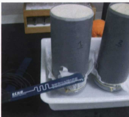
Foto 7. Cilindro de PVC diseñado con suelo para calibrar los sensores en laboratorio.
