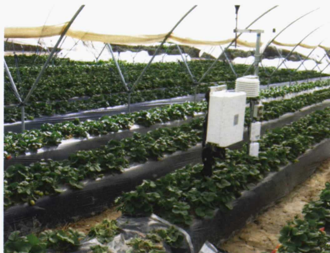
Foto 6. Detalle de instalación de minipluviómetros modelo ECRN para la monitorización automatizada del riego. Foto 6. Conjunto de instrumentación usada y ubicación en la parcela.
