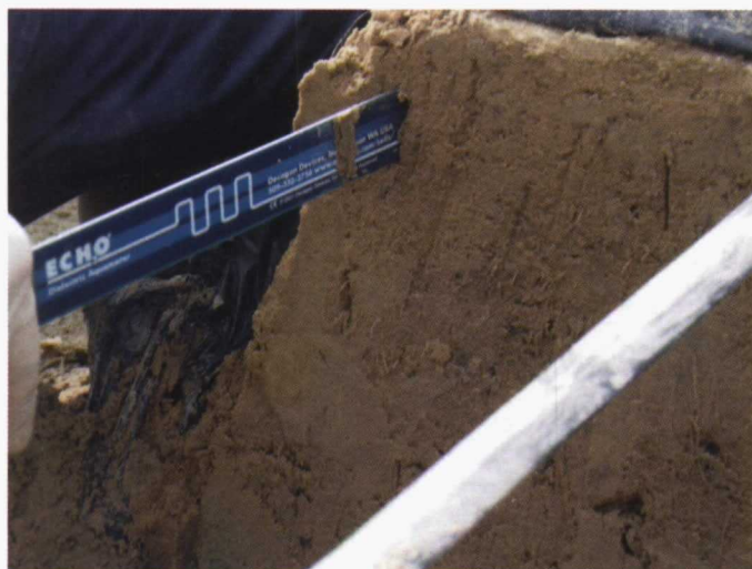
Foto 3. Inserción del sensor EC-20 en el suelo. Foto 4. Red de medida para evaluar la humedad del lomo.
