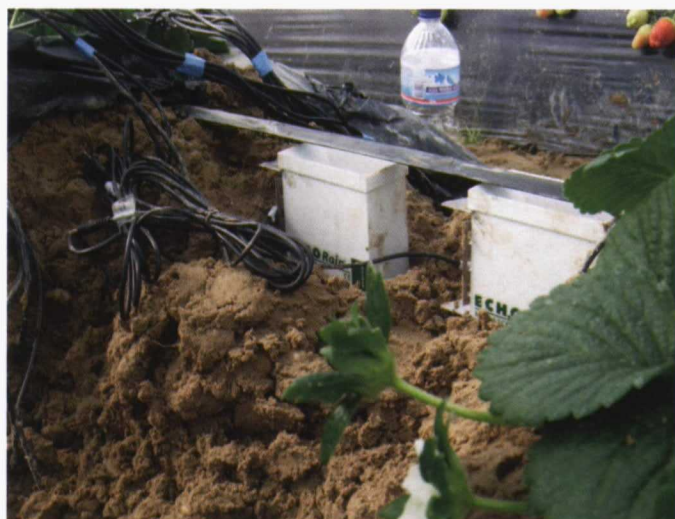
Foto 6. Detalle de instalación de minipluviómetros modelo ECRN para la monitorización automatizada del riego. Foto 6. Conjunto de instrumentación usada y ubicación en la parcela.
