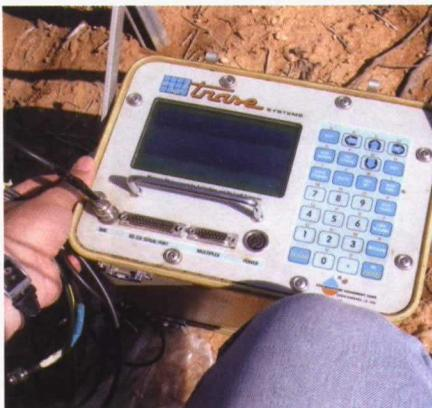
Foto izquierda: Guías de TDR fijadas para medir el contenido volumétrico de agua en el suelo a diferentes profundidades. Foto derecha: Equipo de medición y registro de las sondas TDR.
