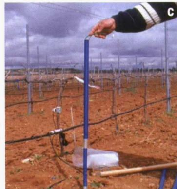
Sensores de matrix granular: a) Watermark. b) Datalogger de Watermark para el registro manual de las lecturas. c) Colocación de dos sensores Watermark en un tubo de plástico para situarlos en campo en un mismo punto de muestreo a dos profundidades.
