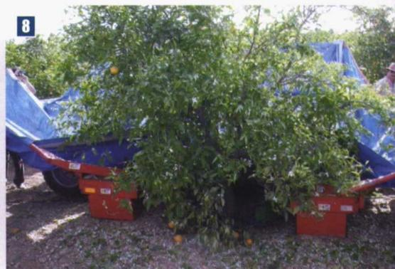
Foto 6. Vibrador de troncos unidireccional. Foto 7. Vibrador de troncos con estructura de recepción (plataforma inclinada). Foto 8. Vibrador con paraguas invertido.
