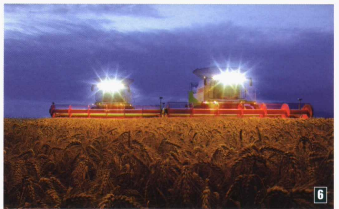
Fotos 1, 2 y 3. Dentro del segmento de mayor capacidad se han incrementado las capacidades de tolva y la velocidad de descarga de ésta. Fotos 4 y 5. Los sistemas de nivelación, así como las ayudas para la detección de la cosecha, tienen cada vez una mayor presencia en las cosechadoras. Foto 6. Los focos de trabajo son un aspecto mejorado para lograr una óptima visibilidad en cualquier momento y así poder alargar las jornadas de trabajo.
