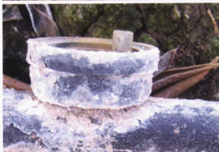
Foto 2. Obturaciones químicas en emisores por incorrecto manejo de aguas con pH elevado y alto contenido en bicarbonatos.
