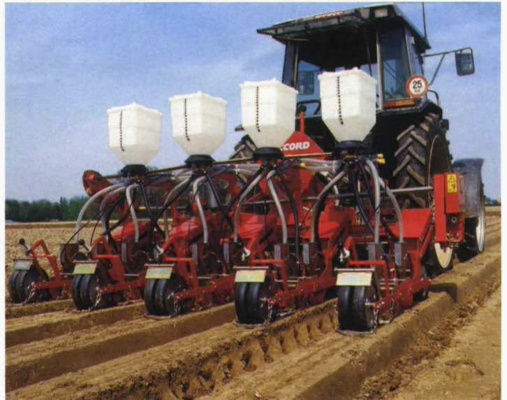
Foto izda. Unidad de siembra formada por tolva, disco dosificador, reja abresurco y rueda compactadora. Foto derecha. Sembradora neumática diseñada para la siembra de semillas pequeñas, tales como las hortalizas.
