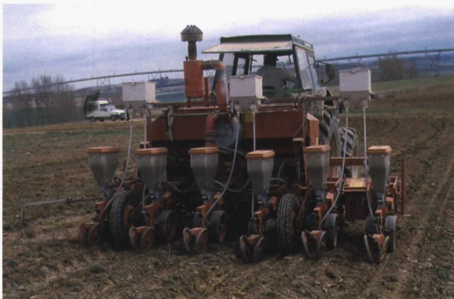
Sembradora monograno de seis líneas con tolvas para abono y microgánulos.
