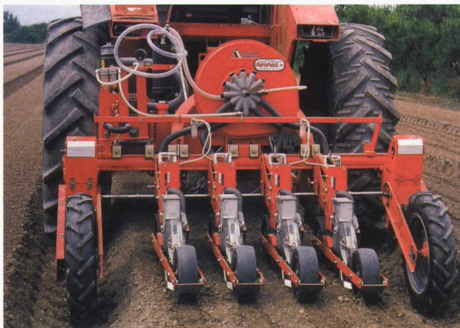
Sembradora monograno neumática de cuatro líneas de siembra con dos ruedas de accionamiento de los discos dosificadores.
