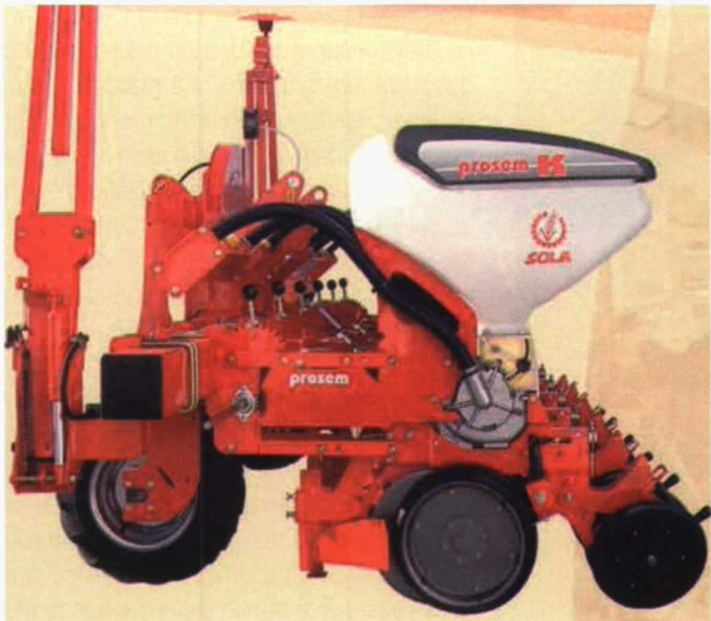
Foto izda. Unidad de siembra formada por tolva, disco dosificador, reja abresurco y rueda compactadora. Foto derecha. Sembradora neumática diseñada para la siembra de semillas pequeñas, tales como las hortalizas.
