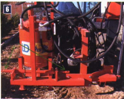
Foto 6. Puntos de conexión en las traseras del bastidor de la prepodadora para montarla en el enganche delantero del tractor.
