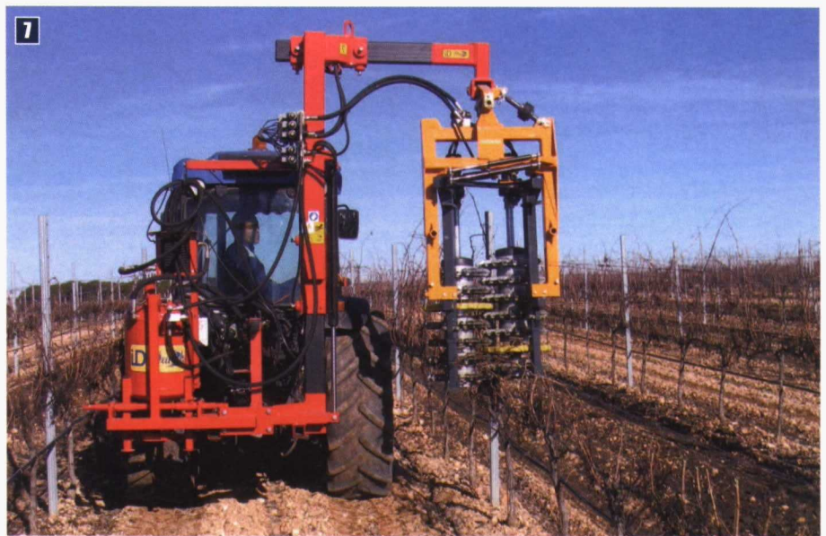
Foto 6. Puntos de conexión en las traseras del bastidor de la prepodadora para montarla en el enganche delantero del tractor.
