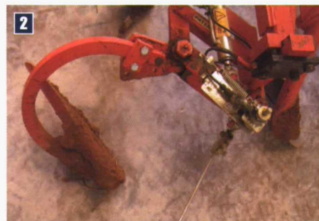
Foto 2. Reja unida a un brazo del paralelogramo (izquierda) y al brazo sometido a movimientos paralelogramáticos y radial (derecha).
