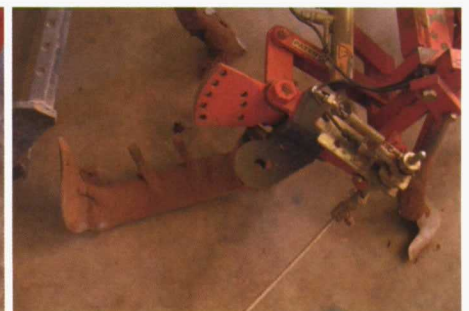
Foto 2. Reja unida a un brazo del paralelogramo (izquierda) y al brazo sometido a movimientos paralelogramáticos y radial (derecha).
