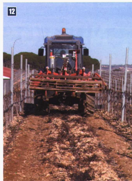
Foto 11. Barredora de restos de poda con los extremos de las gomas barredoras rozando con los troncos de las cepas.
