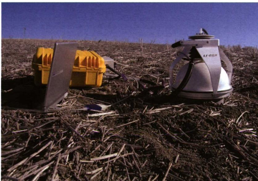
Instrumento de medida de las emisiones de CO 2 del suelo.
