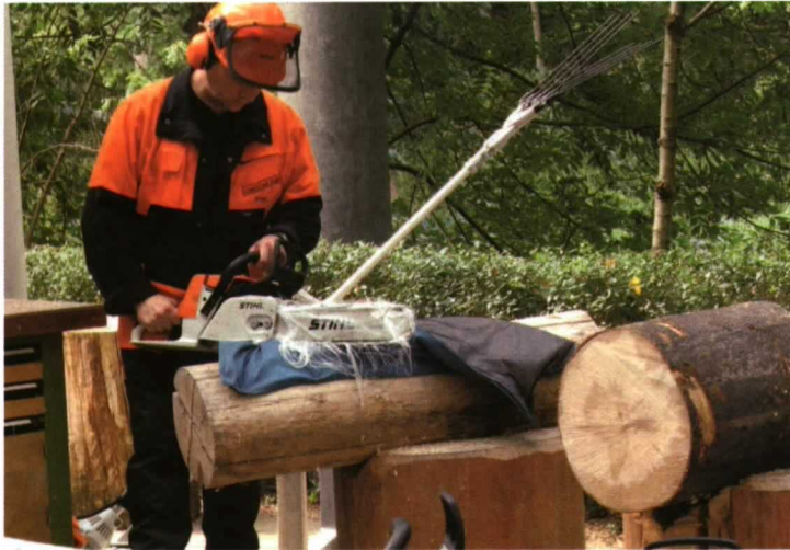
Motosierra con la cadena detenida por las fibras del tejido con el que se fabrican pantalones de protección.
