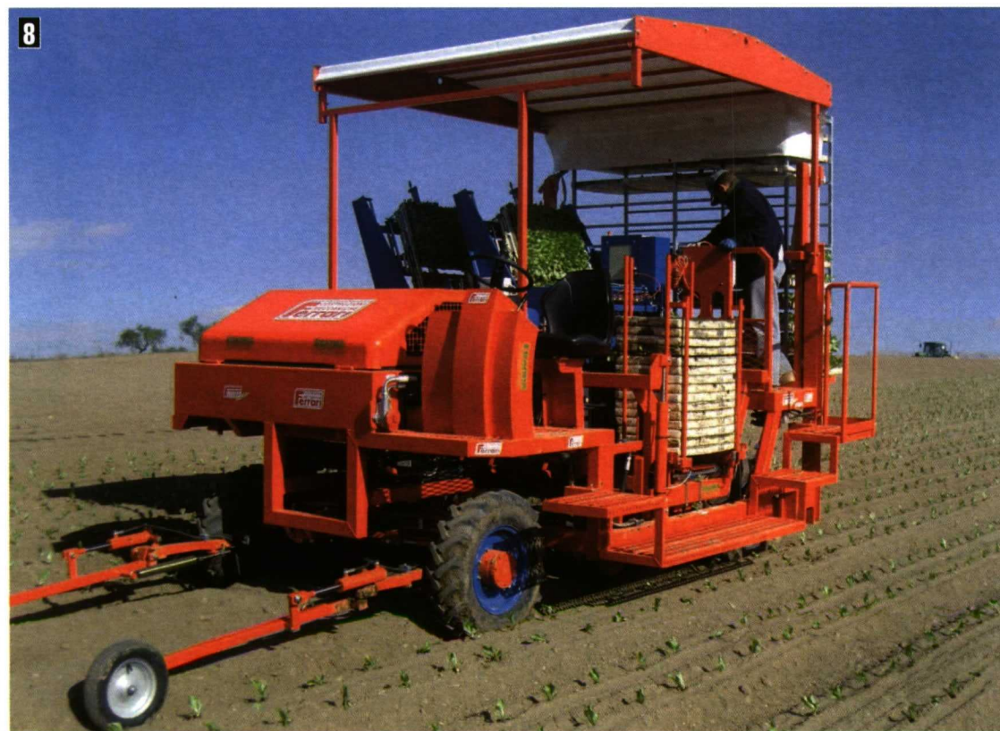
Foto 8. Gracias a los palpadores delanteros, la dirección de la máquina es automática y el operario puede ocuparse de revisar el trasplante.
