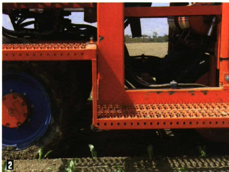
Foto 2. Las ruedas traseras asientan el terreno y marcan la profundidad del trasplante.
