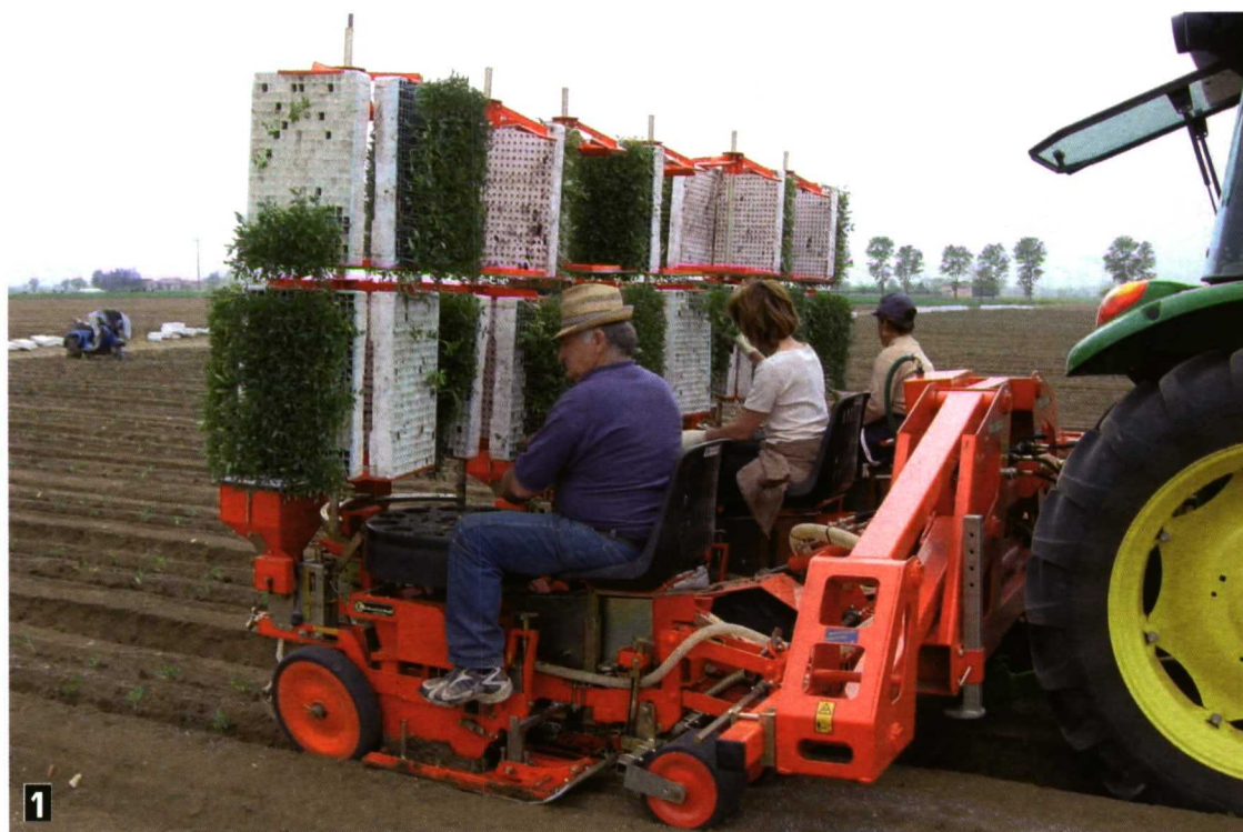
Foto 1. En estas trasplantadoras se requiere una alimentación continua por parte del operario.
