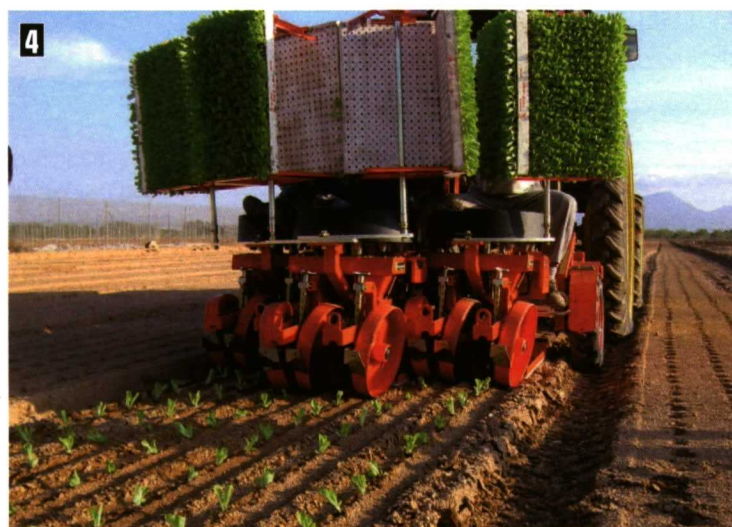
Foto 4. La orientación apropiada de los discos compactadores son imprescindibles para garantizar el asentamiento de las plántulas en el terreno definitivo.
