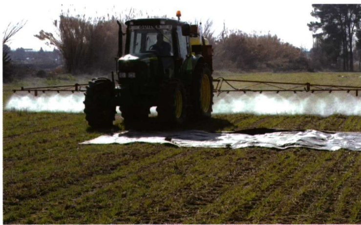
Aunque en menor cuantía, quien lo desee también puede encontrar en el mercado abonadoras y pulverizadores cuyos sistemas de dosificación reciban órdenes desde el ordenador instalado en el tractor, lo cual les hará variar la dosis en cada zona del punto del terreno sobre la que se encuentren.
