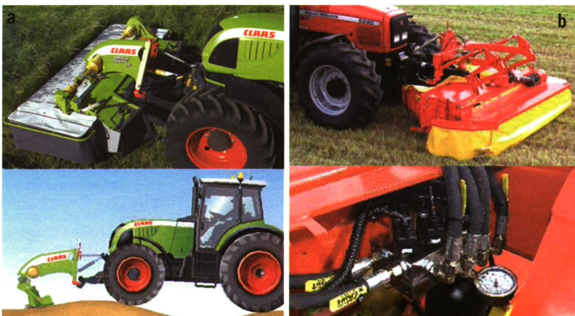
Foto 3. Adaptación de segadoras rotativas a los desniveles del terreno: a) trapezio tirante con resorte en segadora frontal (Claas) y b) suspensión oleo-neumática en segadoras (Elho).
