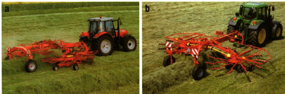
Foto 7. Rastrillos hileradores Kuhn: a) de doble rotor con hidro-rotos, y b) de doble rotor con accionamiento mecánico.
