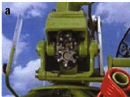
Foto 6. Detalle de la conexión mecánica entre molinetes en rastrillos henificadores: a) Claas y b) John Deere.
