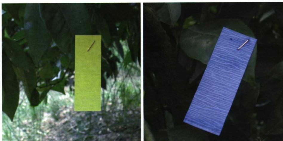
Foto 2. Ejemplos de papeles hidrosensibles tras la pulverización.
