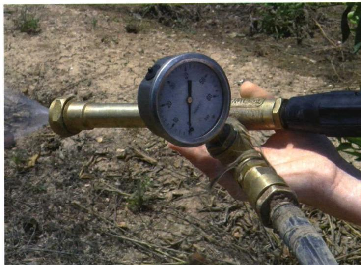
Foto 1. Pistola de pulverización con manómetro empleada en los ensayos.
