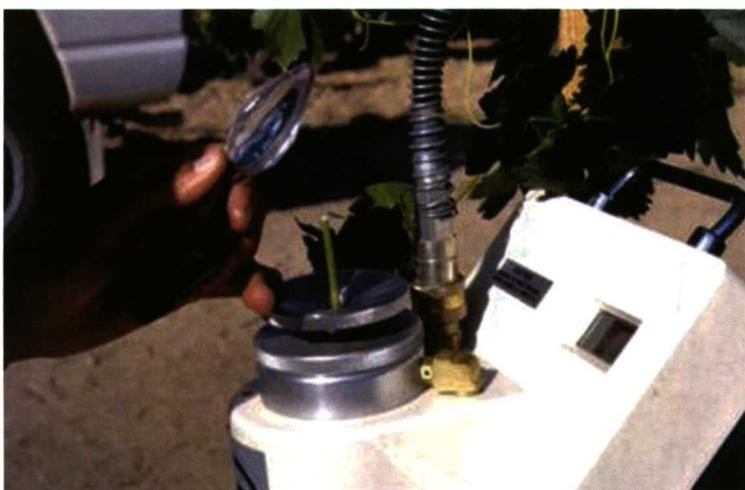
**Foto izqda.** Medida del potencial hídrico con cámara de presión.
