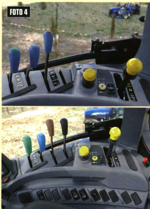
Foto 4. Los controles laterales de ambos modelos muestran una disposición similar (arriba: 6070 Grande; abajo: 6030 Delta).
