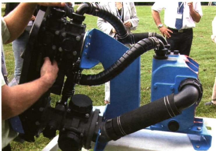
Foto 9. Detalle del sistema de bombeo que permite reducir el volumen residual del depósito del pulverizador (Foto: Berthoud).
