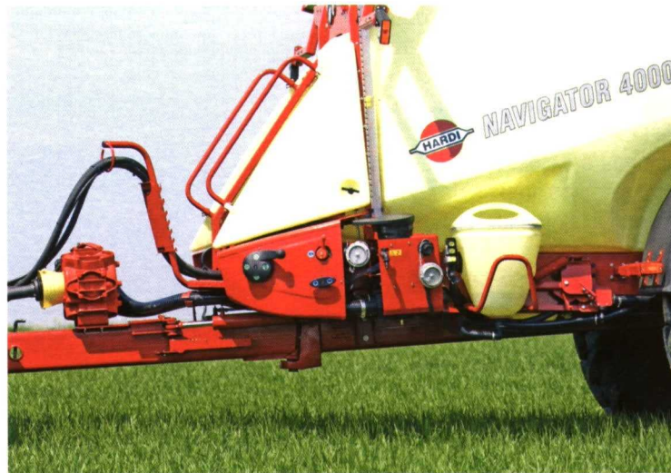
Foto 10. Pulverizador arrastrado con sistema inteligente de trazado, incorporador de fitosanitarios y filtros especiales. (Foto: Hardi).
