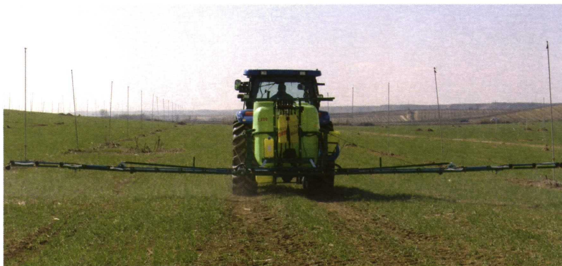
Foto 1. Pulverizador hidráulico para las aplicaciones en cultivos herbáceos. (Foto: Alba Fillat)
