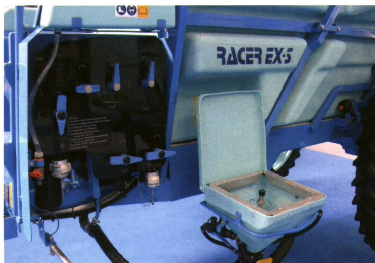
Foto 5. Incorporador de producto y valvulería para la limpieza del depósito integrados en el pulverizador. (Foto: Ferran Camp).
