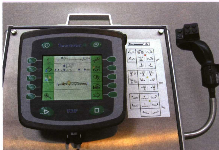
Foto 2. Dispositivo que permite controlar la barra de pulverización (altura, sectores, dosis, etc.) con una sola mano. (Foto: Ferran Camp)
