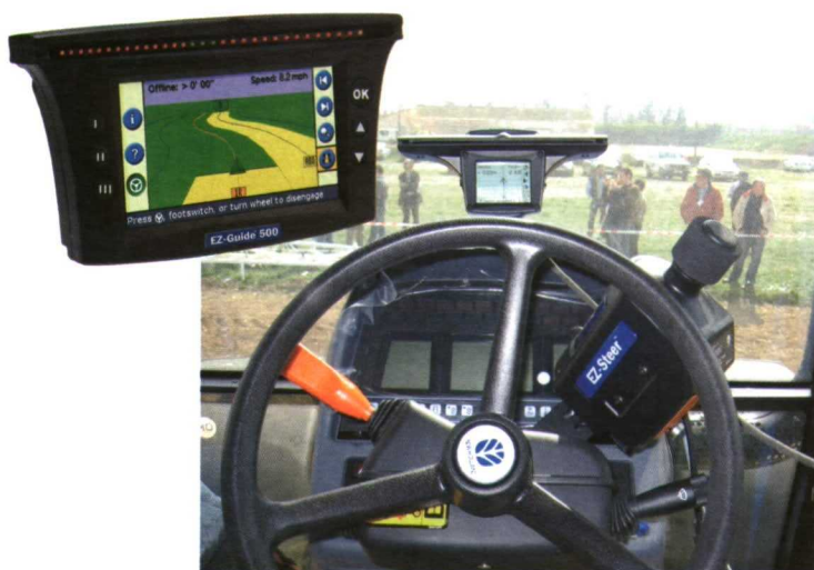
Foto 3. Dispositivo de autoguiado por GPS que marca la trayectoria a seguir para evitar solapamientos o zonas sin tratar. (Foto: Ferran Camp/Aams).
