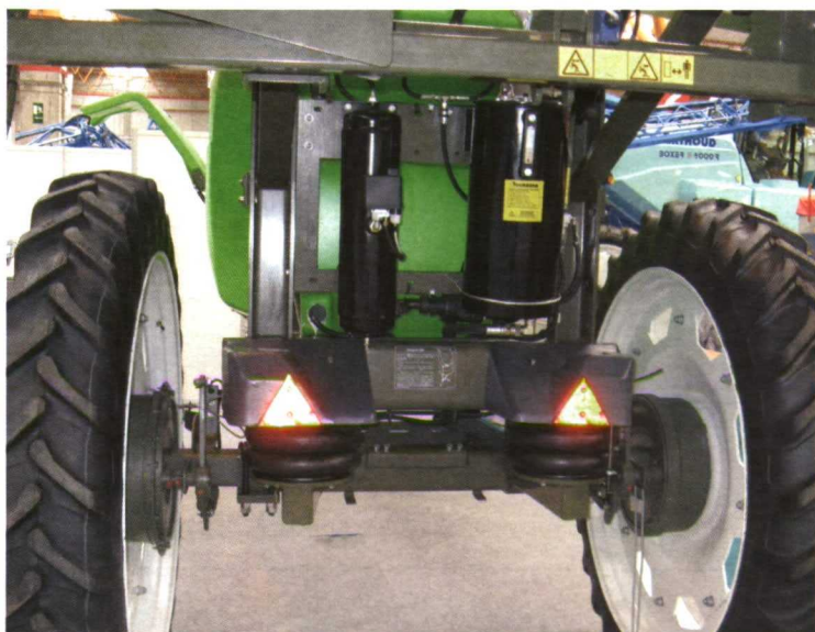
Foto 4. Sistema de amortiguación en las ruedas de un pulverizador arrastrado para mejorar la estabilidad de la barra. (Foto: Ferran Camp)
