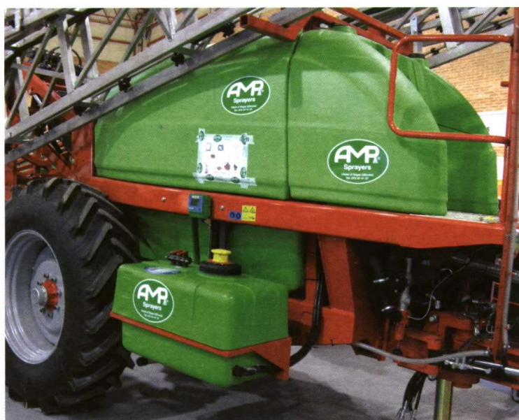
Foto 11. Pulverizador equipado con un dispositivo de inyección directa del producto previamente mezclado en un depósito adicional. (Foto: Ferran Camp).
